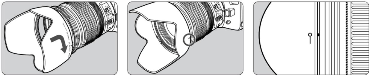
安装遮光罩时，将遮光罩的安装位置标记对准镜头前部的红色圆点，然后按箭头所示的方向转动遮光罩，直至镜头的红色圆点与遮光罩停止位置标记排成一线。
