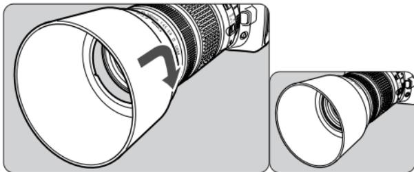
遮光罩 ET-65B 能够阻挡不必要的光线进入镜头，并能保护镜头，使其避免受到雨、雪和灰尘的侵扰。将遮光罩安装和调整至镜头前面的遮光罩座上，按箭头所示方向旋转遮光罩以将其固定。可以将遮光罩反面安装在镜头上以便存放。
