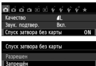
На вкладке [CAMERA 1], выберите пункт [**Спуск затвора без карты**], затем нажмите кнопку <SET>. Выберите пункт [**Запрещён**] и нажмите кнопку <SET>. Если карта памяти не установлена и нажата кнопка спуска затвора, в видоискателе появится сообщение «**Card**» и спуск затвора будет невозможен.
