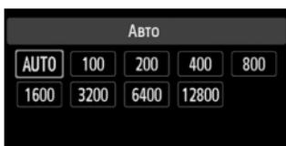
Если для чувствительности ISO задано значение **[AUTO]**, фактически устанавливаемое значение чувствительности ISO отображается при нажатии кнопки спуска затвора наполовину. Как указано на следующей странице, чувствительность ISO автоматически устанавливается в соответствии с режимом съемки.
