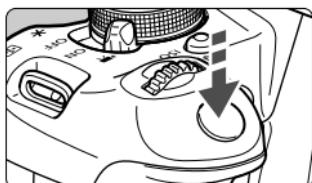
Во время видеосъемки можно сделать снимок, полностью нажав кнопку спуска затвора.
