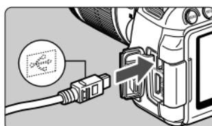
**2 С помощью прилагаемого интерфейсного кабеля подсоедините камеру к персональному компьютеру.**
