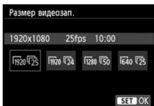
Пункт меню [**2: Размер видеозап.**] позволяет выбрать размер изображения для видеозаписей [\*\*\*\*x\*\*\*\*] и частоту кадров [\*\*\*\*] (количество записываемых кадров в секунду). Параметр \*\*\*\* (частота кадров) автоматически переключается в зависимости от настройки значения [**2: ТВ-стандарт**].
