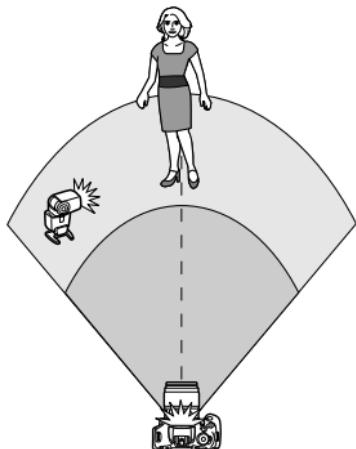
В этом разделе приведены инструкции по полностью автоматической съемке со внешней вспышкой Speedlite и встроенной вспышкой с беспроводным управлением. Можно изменить соотношение мощностей внешней вспышки Speedlite и встроенной вспышки для желаемой подсветки теней. На экранах меню значки <> и <> обозначают внешнюю вспышку Speedlite, а значки <> и <> обозначают встроенную вспышку.
