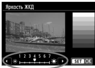
При проверки экспозиции изображения установите яркость ЖК-дисплея на значение 4 и следите, чтобы внешние освещение не влияло на просматриваемое изображение.
