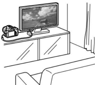
Для подсоединения камеры к телевизору используйте аудио/видеокабель AVC-DC400ST или кабель HDMI HTC-100 (продается отдельно). После этого можно просматривать сделанные видеозаписи и фотографии на экране телевизора. При наличии телевизора высокой четкости (High-Definition TV) можно подключить камеру к нему HDMI-кабелем и просматривать видеозаписи с повышенным качеством изображения по стандартам Full High-Definition (Full HD: 1920x1080) и High-Definition (HD: 1280x720).
