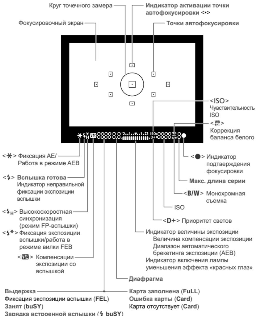
На экране отображаются только установки, применимые к текущему режиму.
