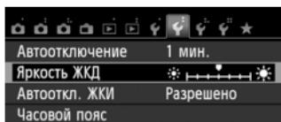
На вкладке [F2], выберите [**Яркость ЖКД**], затем нажмите <**SET**>. Когда отображается экран настройки, кнопками <**↔**> отрегулируйте яркость, затем нажмите кнопку <**SET**>.
