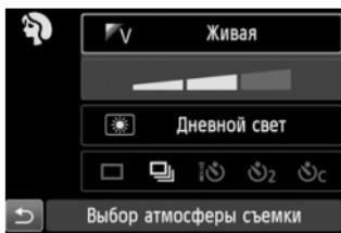
Когда в режимах базовой зоны отображается экран параметров съемки, можно нажать кнопку <Q> для отображения экрана быстрой настройки. В приведенной ниже таблице указаны функции, которые можно задать с помощью экрана быстрой настройки в каждом режиме базовой зоны.
