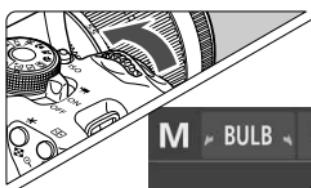
В режиме ручной длительной выдержки затвор остается открытым до тех пор, пока кнопка спуска затвора удерживается нажатой. При помощи этой функции можно фотографировать фейерверки и другие сюжеты, требующие длительных выдержек. В шаге 3 на предыдущей странице поверните диск <BULB>. На ЖК-дисплее отображается истекшее время экспонирования.
