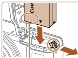
Контакты      Фиксатор аккумулятора
