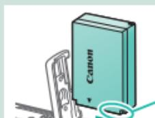
Einsetzen/Entnehmen des Akkus
