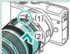
Anbringen eines EF- oder EF-S-Objektivs
