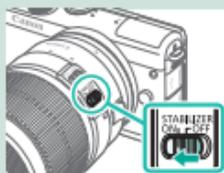
Verwenden der Bildstabilisierung von EF- oder EF-S-Objektiven
