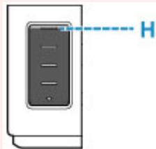
8. Cuando la tinta alcance la línea de límite superior, extraiga el frasco de tinta de la entrada.
