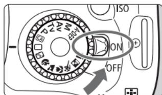
**5** Positionnez le commutateur d'alimentation de l'appareil photo sur <ON>.
