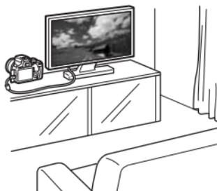
Utilisez le câble AV fourni ou un câble HDMI HTC-100 (vendu séparément) afin de raccorder l'appareil photo à un téléviseur. Vous pourrez ensuite visionner les vidéos et photos capturées sur votre téléviseur.
