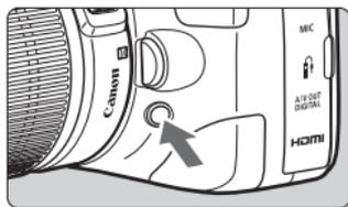
Appuyez sur la touche de contrôle de profondeur de champ pour redescendre à l'ouverture actuelle de l'objectif. Vous pouvez ensuite vérifier la profondeur de champ (plage de mise au point acceptable) dans le viseur.
