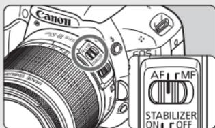
**Positionnez le sélecteur de mode de mise au point de l'objectif sur <AF>.** (p.33)
