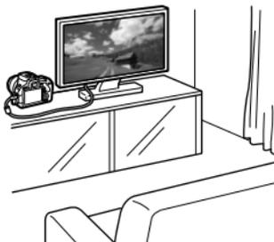
Utilize o cabo AV fornecido ou um Cabo HDMI HTC-100 (vendido em separado) para ligar a câmara a um televisor. Em seguida, pode reproduzir os filmes e as fotografias captados no televisor. Se tiver um televisor de Alta Definição e ligar a câmara ao mesmo utilizando um cabo HDMI, pode ver filmes em Full HD (Alta Definição Total: 1920 x 1080) e HD (Alta Definição: 1280 x 720) com uma imagem de qualidade superior.
