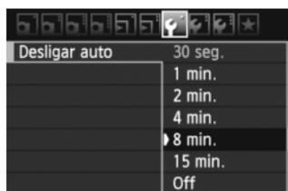
No separador [🔍], seleccione [Desligar auto] e carregue em <ⓈET>. Seleccione a definição pretendida e carregue em <ⓈET>.
