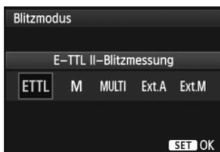
**[E-TTL II Blitzmessung]** ist der Standardmodus für Aufnahmen mit automatischem Blitz bei Verwendung von Speedlite-Blitzgeräten der EX-Serie. Im Modus **[Manueller Blitz]** können Sie die **[Blitzleistungsstufe]** selbst einrichten. Informationen zu weiteren Blitzmodi finden Sie in der Bedienungsanleitung des Speedlite.
