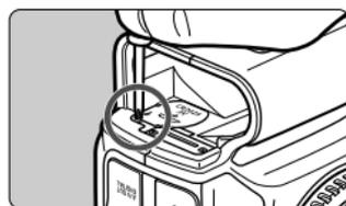
**3 Entfernen Sie die Abdeckung der Speicherbatterie.**
