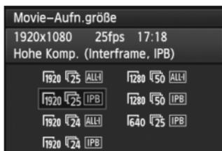
Mit [CAM: 4: Movie-Aufn.größe] können Sie die Bildgröße, Bildrate pro Sekunde und Komprimierungsmethode des Movies festlegen. Die Bildrate wechselt automatisch je nach der Einstellung für [CAM: 3: Videosystem].
