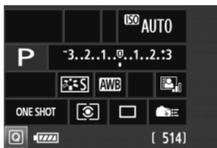
Wenn Sie die Taste <INFO.> mehrmals gedrückt haben, werden die Aufnahmeeinstellungen angezeigt. Durch Drücken der Taste <Q> wird die Schnelleinstellung der Aufnahmeeinstellungen aktiviert (S. 51). Drücken Sie die Taste <INFO.> erneut, um die Anzeige auszuschalten.
