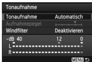
Während einer Movie-Aufnahme können Sie den Ton mit dem integrierten Mono-Mikrofon oder einem in Handel erhältlichen Stereo-Mikrofon aufnehmen. Die Lautstärke für die Tonaufnahme können Sie frei bestimmen. Einstellungen zur Tonaufnahme können Sie unter **[CAMERA 4: Tonaufnahme]** vornehmen.
