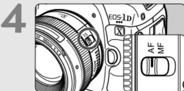
**Stellen Sie den Modus-Schalter für die Fokussierung des Objektivs auf <AF>** (S. 43).
