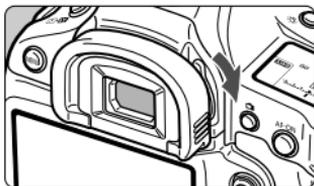
Wenn Sie den Selbstauslöser oder die Langzeitbelichtung verwenden und ein Bild aufnehmen, ohne durch den Sucher zu blicken, kann die Belichtung durch in das Okular einfallendes Streulicht beeinflusst werden, was zu einem dunklen Bild führt. Um dies zu verhindern, schieben Sie den Riegel des Okularverschlusses wie gezeigt in Pfeilrichtung, um das Okular zu verschließen. Bei Livebild- oder Movie-Aufnahmen müssen Sie das Okular nicht verschließen.
