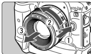
**Drücken Sie die Taste zur Objektivverriegelung, und drehen Sie gleichzeitig das Objektiv in die angegebene Pfeilrichtung.**
