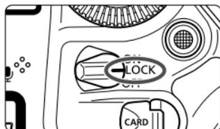
Wenn der Hauptschalter auf <LOCK> gestellt ist und Sie versuchen, eines der gesperrten Kamera-Bedienelemente zu verwenden, wird im Sucher und auf der oberen LCD-Anzeige <L> angezeigt. Auch auf dem Bildschirm für die Einstellung der Aufnahmefunktionen wird [LOCK] angezeigt.
