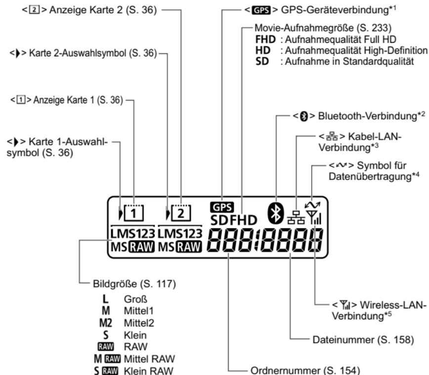
\*1 : Wird angezeigt, wenn der GPS-Empfänger GP-E1/GP-E2 an der Kamera angebracht ist oder wenn ein handelsübliches Bluetooth GPS-Gerät an den Wireless File Transmitter WFT-E6 angeschlossen ist.
