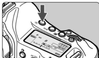
Drücken Sie die Taste <☀>, um die Beleuchtung der oberen und hinteren LCD-Anzeige ein- (☀) bzw. auszuschalten. Wenn Sie während einer Langzeitbelichtung den Auslöser ganz durchdrücken, wird die Beleuchtung der LCD-Anzeige ausgeschaltet.
