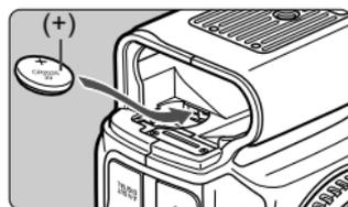
**5 Setzen Sie eine neue Speicherbatterie ein.**
