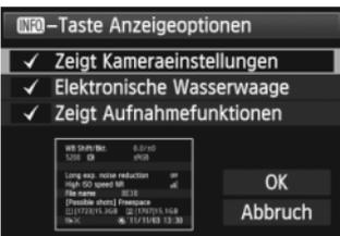
Wenn Sie die Taste <INFO.> drücken, während die Kamera aufnahmebereit ist, können Sie **[Zeigt Kameraeinstellungen]**, **[Elektronische Wasserwaage]** (S. 61) und **[Zeigt Aufnahmeoptionen]** (S. 359) anzeigen.
