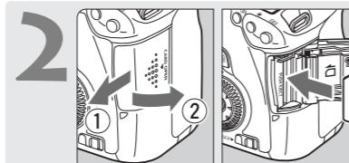
插入存储卡。令存储卡的标签朝向相机的背面，将其插入存储卡插槽。
