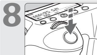
拍摄照片。完全按下快门按钮拍摄照片。
