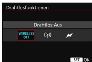
Über optische oder Funkübertragung können Sie drahtlos (mehrfache) Blitzaufnahmen vornehmen. Einzelheiten zu den Drahtlosfunktionen finden Sie in der Bedienungsanleitung eines Speedlite welches mit Aufnahmen mit drahtlosem Blitz kompatibel ist.
