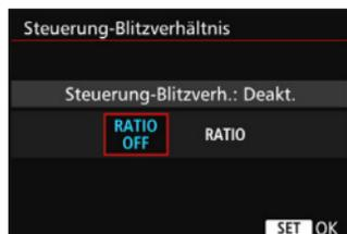
Mit einem Makroblitzgerät (MR-14EX II usw.), das mit den externen Blitzfunktionseinstellungen kompatibel ist, können Sie das Blitzverhältnis zwischen den Blitzröhren oder Blitzköpfen A und B einstellen. Alternativ können Sie einen Drahtlos-Blitz mit Slave-Einheiten verwenden. Einzelheiten zur Blitzverhältnissteuerung erhalten Sie in der Bedienungsanleitung des Makroblitzgeräts.
