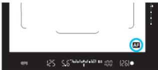
Wenn Sie den Auslöser halb durchdrücken und die Kamera mit AF fokussiert, wird unten rechts im Sucher das Symbol <AF> angezeigt.
