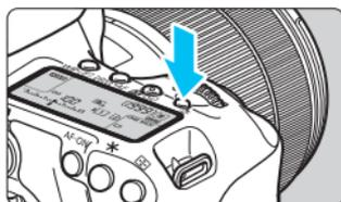
Sie können die Beleuchtung der LCD-Anzeige einschalten (☀6)/auschalten, indem Sie die Taste <☀> drücken. Wenn Sie während einer Langzeitbelichtung den Auslöser ganz durchdrücken, wird die Beleuchtung der LCD-Anzeige ausgeschaltet.
