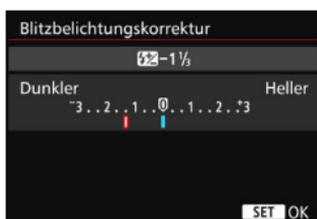
Sie können eine Blitzbelichtungskorrektur in Drittelstufen um bis zu  $\pm 3$  Stufen einstellen. Einzelheiten hierzu finden Sie in der Bedienungsanleitung des Speedlite.
