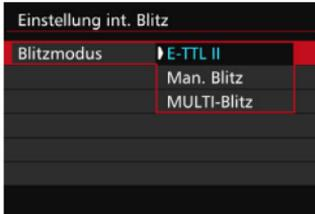
Diese Funktion sollten Sie normalerweise auf **[E-TTL II]** stellen. Dies aktiviert Aufnahmen mit automatischer Belichtung mit dem internen Blitz.
