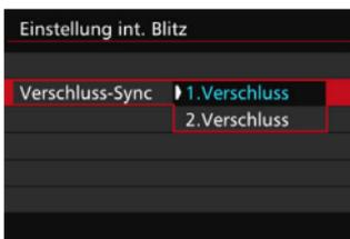
Im Normalfall sollten Sie hier **[1. Verschluss]** einstellen, damit der Blitz gleichzeitig mit Belichtungsbeginn ausgelöst wird.
