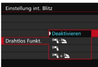
Bei Fotografie mit drahtlosen Blitzgeräten (über optische Übertragung) können Sie den internen Blitz verwenden, um externe Speedlites drahtlos zu steuern. Weitere Informationen finden Sie unter „Verwenden von drahtlosen Blitzgeräten“ auf Seite 272.
