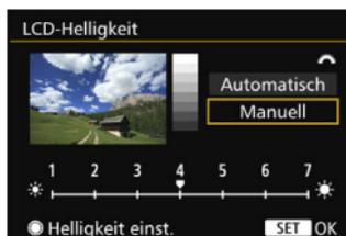
**!** Achten Sie bei Einstellung von [Automatisch] darauf, dass Sie den runden Umgebungslichtsensor (S. 24) links unterhalb des Schnellwahlrads nicht mit dem Finger o. ä. verdecken.
