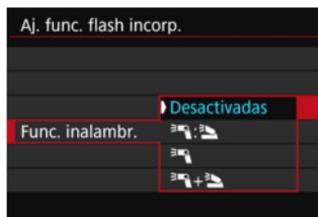
Con la fotografía con flash inalámbrico (mediante transmisión óptica), puede utilizar el flash incorporado para controlar flashes Speedlite externos de manera inalámbrica.
