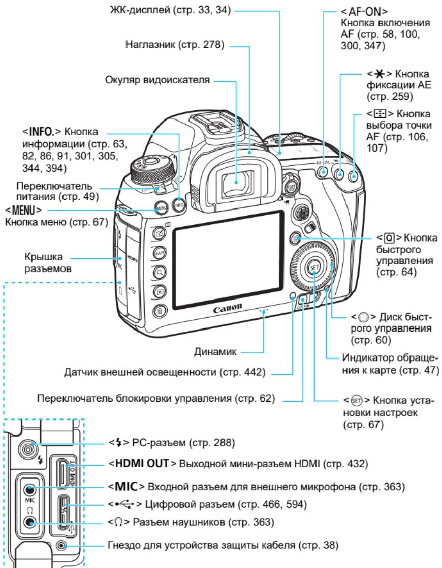
При подключении интерфейсного кабеля к цифровому разъему используйте прилагаемое устройство защиты кабеля (стр. 38).
