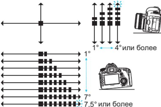
Даже при скорректированном наклоне допустимый предел погрешности составляет примерно  $\pm 1^\circ$ .
