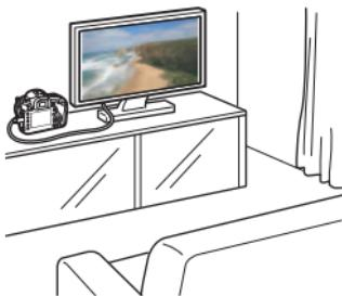
Подключив камеру к телевизору с помощью HDMI-кабеля HTC-100 (продаётся отдельно), можно просматривать на телевизоре фотографии и видео с камеры.
