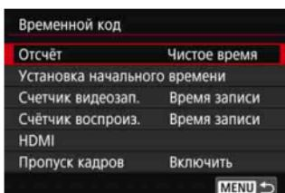
Временной код содержит информацию о времени, записываемую автоматически для синхронизации видео во время видеосъемки. Запись временного кода всегда выполняется в следующих единицах: часы, минуты, секунды и кадры. В основном временной код используется при видеомонтаже.
