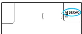
Этот режим AF предназначен для съемки движущихся объектов, когда расстояние фокусировки постоянно изменяется. Пока кнопка спуска затвора удерживается наполовину нажатой, камера будет продолжать фокусировку на объект.
