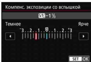
Величину компенсации экспозиции вспышки можно устанавливать в интервале  $\pm 3$  ступени с шагом  $1/3$  ступени. Подробнее см. в инструкции по эксплуатации вспышки Speedlite.
