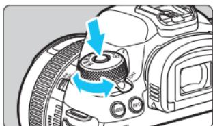
**Поверните диск, удерживая нажатой центральную кнопку разблокировки диска.**
