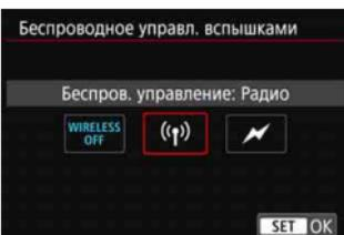
Съемка с одной или несколькими беспроводными вспышками возможна при помощи радио- или оптической передачи.
