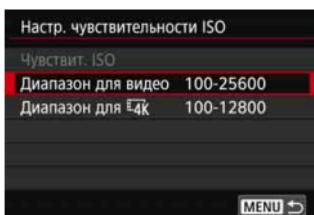
Если переключатель «режим Live View/видеосъемка» установлен в положение <>, настройки в параметре [■ 2: Настр. чувствительности ISO] изменяются на [Чувствительность ISO], [Диапазон для видео] и [Диапазон для 4K].
