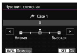
Установка чувствительности отслеживания фокусировки на объект в режиме AI Servo AF при появлении препятствия в точках AF или при выходе объекта за пределы точек AF.
