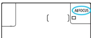
В режиме AI Focus AF осуществляется автоматическое переключение из режима покадрового AF в режим AI Servo AF, если объект съемки начинает двигаться.
