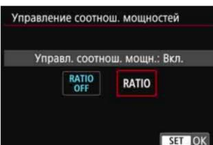
При использовании вспышки для макросъемки (MR-14EX II и т. д.), совместимой с настройками вспышки, можно задавать соотношение мощностей ламп-вспышек или головок вспышки А и В, а также использовать режим беспроводной вспышки с дополнительными ведомыми устройствами.
