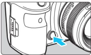
Нажав кнопку предварительного просмотра глубины резкости, можно привести диафрагму объектива в соответствие с текущей установкой и проверить глубину резкости (диапазон приемлемой фокусировки).
