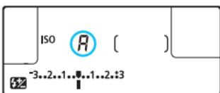
Если для чувствительности ISO задано значение «**A**» (Авто), при наполовину нажатой кнопке спуска затвора отображается фактически устанавливаемое значение чувствительности ISO.
