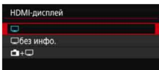
Эта функция позволяет выбирать варианты отображения при записи сигнала с разъема HDMI на внешнем записывающем устройстве. Видеозаписи выводятся с качеством Full HD (1920x1080). Настройка по умолчанию — [**[ ]**].
