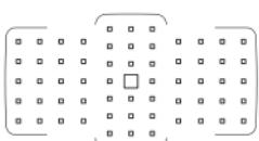
В режиме AI Servo AF можно задать начальную позицию AI Servo AF с помощью параметра [AF4: Нач. тчк AF, (○) AI Servo AF] (стр. 146). Фокусировка продолжается, пока объект остается в пределах рамки области автофокусировки.
