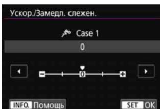
Эта настройка задает чувствительность отслеживания движущихся объектов, скорость которых может быстро изменяться (остановка, начало движения и т. п.).
