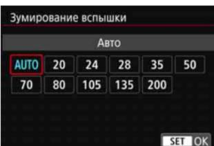
Вспышки Speedlite оснащены головками с зумом, позволяющими задавать охват вспышки. Обычно выбирается режим [AUTO] для автоматического определения охвата вспышки в соответствии с фокусным расстоянием объектива.
