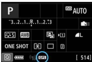
Состояние приема GPS показывает значок [GPS] на ЖК-дисплее камеры.
