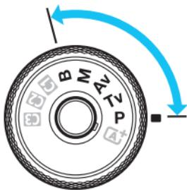
В режимах **<P>**, **<Tv>**, **<Av>**, **<M>** и **<B>** можно изменять различные настройки камеры для получения разнообразных результатов съемки за счет выбора выдержки затвора и/или величины диафрагмы, настройки требуемой экспозиции и т. д.
