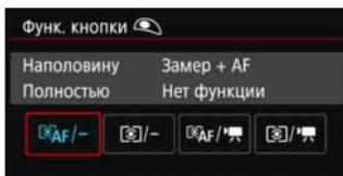
Можно задать функции, выполняемые при нажатии кнопки спуска затвора наполовину или полностью во время видеосъемки.
