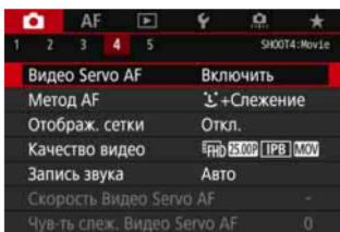
Если переключатель «режим Live View/ видеосъемка» установлен в положение <>, вкладки [**4**] и [**5**] отображаются как пункты меню, относящиеся исключительно к видеосъемке (вкладки [**2**] и [**3**] в режиме <>).
