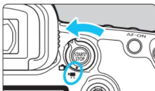
**2 Установите переключатель «режим Live View/видеосъемка» в положение <■>.**
