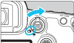
1 Установите переключатель «режим Live View/видеосъемка» в положение < >.
