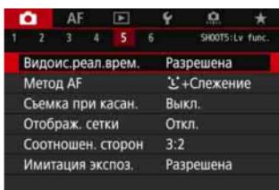
Если переключатель «режим Live View/видеосъемка» установлен в положение <**5**>, пункты меню, относящиеся только к съемке в режиме Live View, доступны во вкладках [**5**] и [**6**] (вкладка [**3**] в режиме <**A<sup>+</sup>**>).
