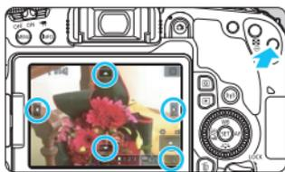
En los modos **[Zona suave]** y **[AF 1 pto dir]**, presione el botón **<Q>** o toque en **[Q]** que se muestra en la esquina inferior derecha de la pantalla. Puede ampliar la imagen aprox. 5 o 10 veces y comprobar el enfoque.
