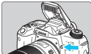
Cuando utilice el flash incorporado o un flash Speedlite serie EX externo compatible con los ajustes de las funciones del flash, puede presionar el botón  $\langle \text{⚡} \rangle$  para mostrar directamente la pantalla [Aj. func. flash incorp.] o [Aj. func. flash externo] sin mostrar primero la pantalla de menús.
