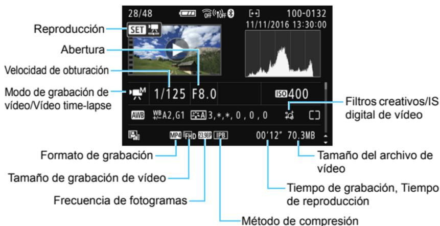
\* Si se utiliza la exposición manual, se mostrará la velocidad de obturación, la apertura y la sensibilidad ISO (si se ajustaron manualmente).
