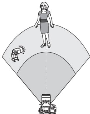
Esta es una fotografía con flash inalámbrico totalmente automático con un flash Speedlite externo y el flash incorporado.
