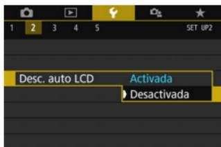
En la ficha [**2**], seleccione [**Desc. auto LCD**] y, a continuación, presione <Ⓢ>. Seleccione [**Desactivada**] y, a continuación, presione <Ⓢ>.
