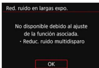
Los elementos de menú atenuados no se pueden ajustar. El elemento de menú aparece atenuado si hay otro ajuste de función que prevalezca sobre él.
