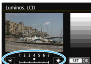
En la ficha [2], seleccione [Luminos. LCD] y, a continuación, presione <SET>. Presione las teclas <◀> <▶> para ajustar la luminosidad en la pantalla de ajuste y, a continuación, presione <SET>.
