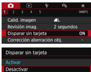
En la ficha [📷1], seleccione [**Disparar sin tarjeta**] y, a continuación, presione <ⓈET>. Seleccione [**Desactivar**] y, a continuación, presione <ⓈET>. Si no hay ninguna tarjeta insertada en la cámara y presiona el disparador, en el visor y en el panel LCD se mostrará “**Tarjeta**” y no podrá realizar el disparo.
