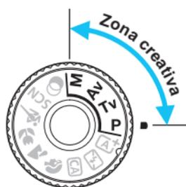
En los modos de la zona creativa, puede cambiar diversos ajustes de la cámara si desea obtener una amplia variedad de resultados fotográficos, seleccionando la velocidad de obturación y/o la apertura, ajustando la exposición que desee, etc.
