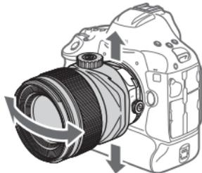
TSレボルビングが直交のときのティルト方向とシフト方向
