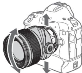
TSレボルビングが平行のときのティルト方向とシフト方向
