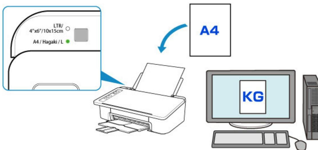
Lorsque vous démarrez une impression, le voyant **Alarme (Alarm)** et le voyant **Papier (Paper)** indiquant le paramètre de format du papier pour l'impression clignotent de manière synchronisée.
