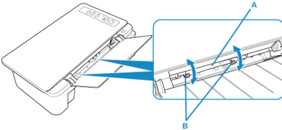
Après avoir nettoyé les rouleaux d'entraînement du papier, mettez la machine sous tension, puis nettoyez à nouveau les rouleaux d'entraînement du papier.
