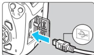
**3 Schließen Sie die Kamera an den Drucker an.**
