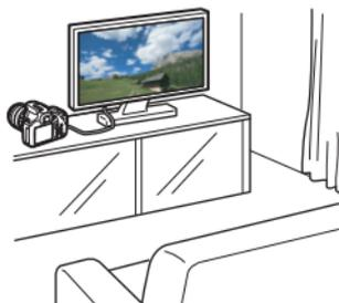
**Ein HDMI-Kabel (separat erhältlich) ist erforderlich, um die Kamera an ein Fernsehgerät anzuschließen.**
