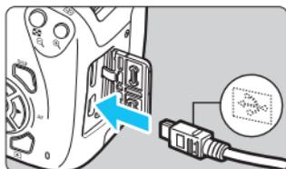
**2** Verbinden Sie die Kamera mithilfe eines Schnittstellenkabels (separat erhältlich) mit dem Computer.
