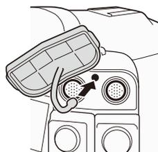
端子カバーの取り付け部を、取り付け口に差し込む。
