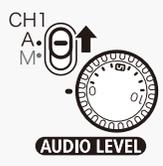
AUDIO LEVEL (録音レベル) 切り換えスイッチをA (オート) にすると、そのチャンネルの録音レベルがオートになり、自動調整されます。
