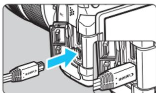
**1 Verbinden Sie das AV-Kabel mit der Kamera.**
