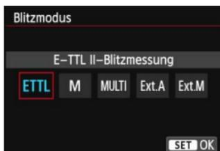
**[E-TTL II Blitzmessung]** ist der Standardmodus für Aufnahmen mit automatischem Blitz bei Verwendung von Speedlite-Blitzgeräten der EX-Serie. Im Modus **[Manueller Blitz]** können Sie die **[Blitzleistungsstufe]** selbst einrichten.
