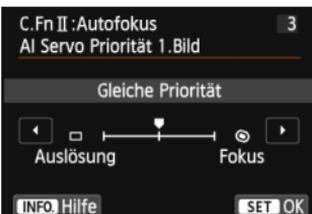
Wenn Sie mit AI Servo AF Reihenaufnahmen machen, können Sie die AF-Betriebsmerkmale und die Auslöse-Einstellung für die erste Aufnahme einstellen.
