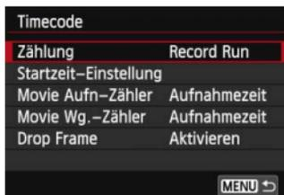
Der Timecode ist ein Zeitreferenzwert, der automatisch aufgezeichnet wird, um Video- und Audiodaten während der Movie-Aufnahme zu synchronisieren. Er wird immer in folgenden Einheiten aufgezeichnet: Stunden, Minuten, Sekunden und Frames. Er wird hauptsächlich während der Bearbeitung von Movies verwendet. Sie können den Timecode mit [**2**: **Timecode**] einstellen.
