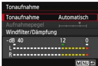
Während einer Movie-Aufnahme können Sie den Ton mit dem integrierten oder einem in Handel erhältlichen Stereo-Mikrofon aufnehmen. Die Lautstärke für die Tonaufnahme können Sie frei bestimmen. Einstellungen zur Tonaufnahme können Sie unter [ **2: Tonaufnahme** ] vornehmen.
