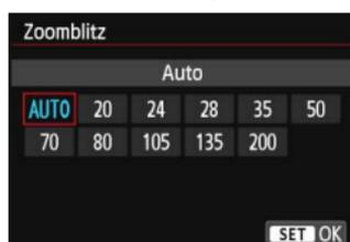
Da Speedlite-Geräte einen einstellbaren Blitzkopf haben, können Sie den Leuchtwinkel variieren. Normalerweise sollte diese Funktion auf **[Auto]** eingestellt sein, sodass die Kamera den Leuchtwinkel automatisch an die Brennweite des Objektivs anpasst.
