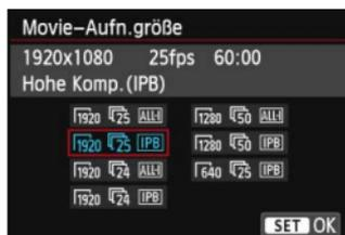
Mit [**2: Movie-Aufn.größe**] können Sie die Bildgröße, Bildrate pro Sekunde und Komprimierungsmethode des Movies festlegen. Die Bildrate wechselt automatisch je nach der Einstellung für [**3: Videosystem**] angepasst.
