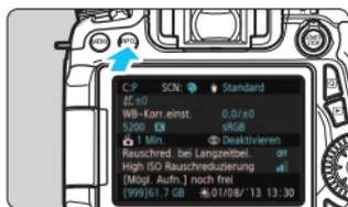
Wenn Sie die Taste <INFO.> drücken, während die Kamera aufnahmebereit ist, können Sie [Zeigt Kameraeinstellungen], [Elektronische Wasserwaage] (S. 65) und [Zeigt Aufnahmefunktionen] (S. 395) anzeigen.
