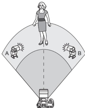
Teilen Sie die Slave-Einheiten in die Gruppen A und B ein, und ändern Sie das Blitzverhältnis je nach gewünschtem Belichtungsergebnis. Befolgen Sie die Anleitungen in der Bedienungsanleitung des Speedlite, um für die Slave-ID der einen Slave-Einheit A (Gruppe A) einzustellen, und für die Slave-ID der anderen Slave-Einheit B (Gruppe B) einzustellen. Positionieren Sie sie dann wie in der Abbildung gezeigt.
