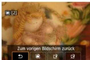
Bevor Sie die Aufnahme der festgelegten Belichtungen beenden, können Sie die Taste <▶> drücken, um das bisher zusammengefügte Bild anzuzeigen. Sie können die Belichtung und das Aussehen des Bildes prüfen. Wenn Sie die Taste <🗑️> drücken, werden die Funktionen angezeigt, die während der Mehrfachbelichtungs-aufnahme verfügbar sind.
