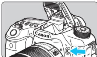
In den Kreativ-Programmen können Sie den internen Blitz einfach ausklappen, indem Sie die Taste  $\langle \text{⚡} \rangle$  drücken, um Blitzlichtaufnahmen zu machen. Um den internen Blitz wieder einzuklappen, drücken Sie ihn mit den Fingern nach unten.
