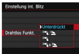
Bei Fotografie mit drahtlosen Blitzgeräten (über optische Übertragung) können Sie den internen Blitz verwenden, um ein externes Speedlite zu steuern.
