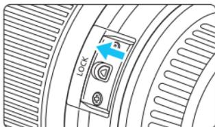
Sie können das Objektiv so einstellen, dass es beim Transport nicht ausfährt. Stellen Sie den Zoom-Ring auf 18 mm Weitwinkелеinstellung, und schieben Sie dann die Zoom-Ring-Verriegelung auf **<LOCK>**. Der Zoom-Ring kann nur bei Weitwinkелеinstellung verriegelt werden.
