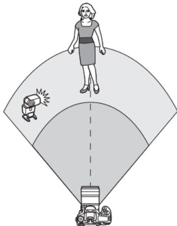
Hier sehen Sie die grundlegende Anordnung für eine vollautomatische Aufnahme mit Blitz mit einem externen Speedlite.
