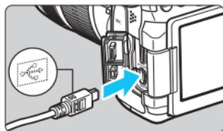
**3** Schließen Sie die Kamera an den Drucker an.
