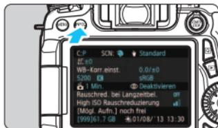
Wenn Sie die Taste <INFO.> drücken, während die Kamera aufnahmebereit ist, können Sie [Zeigt Kameraeinstellungen], [Elektronische Wasserwaage] (S. 65) und [Zeigt Aufnahmefunktionen] (S. 395) anzeigen.
