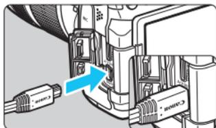
**1 Verbinden Sie das AV-Kabel mit der Kamera.**
