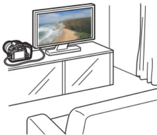
Schließen Sie die Kamera mit dem HDMI-Kabel HTC-100 (separat erhältlich) oder einem Stereo-AV-Kabel AVC-DC400ST (separat erhältlich) an ein Fernsehgerät an. So können Sie die aufgenommenen Movies und Standbilder auf dem Fernsehgerät ansehen.
