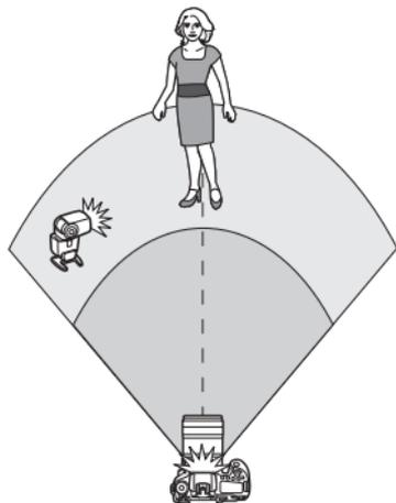
Dies ist eine vollautomatische Aufnahme mit Blitz mit einem externen Speedlite und dem internen Blitz.
