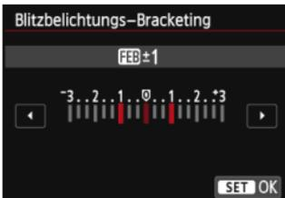
Es werden drei Aufnahmen gemacht, während sich die Blitzleistung automatisch ändert. Weitere Informationen hierzu finden Sie in der Bedienungsanleitung eines mit Blitzbelichtungs-Bracketing kompatiblen Speedlite.
