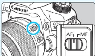
**Stellen Sie den Modus-Schalter für die Fokussierung des Objektivs auf <AF>** (S. 40).
