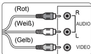
**2 Verbinden Sie das AV-Kabel mit dem Fernsehgerät.**
