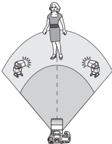
Diese Anordnung ist besonders hilfreich, wenn Sie eine hohe Blitzleistung benötigen. Alle Slave-Einheiten werden mit der gleichen Leistung ausgelöst und so gesteuert, dass eine Standardbelichtung erreicht wird. Ungeachtet der Slave-ID (A, B oder C) werden alle Slave-Einheiten als eine Gruppe ausgelöst.
