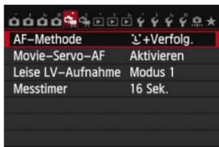
Wenn Sie den Schalter für Livebild-Aufnahmen/Movie-Aufnahmen auf <☺+Verfolg.> setzen, werden die für die Movie-Aufnahme spezifischen Registerkarten [☺+1] und [☺+2] angezeigt.
