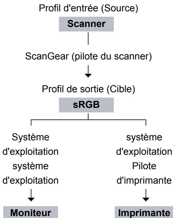
L'espace colorimétrique de l'image est converti en sRGB par ScanGear à partir de l'espace colorimétrique du scanner.
