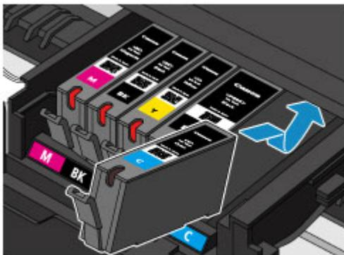
**(2)** Drücken Sie oben auf die Tintenpatrone, bis die Tintenpatrone hörbar einrastet.
