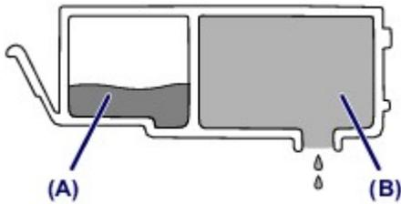
Wenn die Tinte in **(A)** fast aufgebraucht ist, blinkt die Anzeige für Tintenbehälter langsam, um Sie zu informieren, dass die Tinte zur Neige geht.
