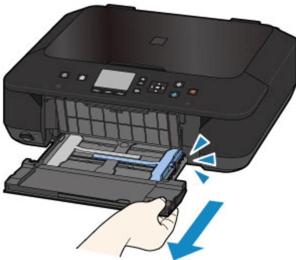
(3) Schieben Sie beide Papierführungen mithilfe der rechten Papierführung (A) vollständig nach außen.
