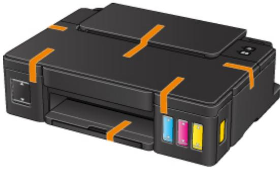
9. Coloque material de protección a ambos lados de la impresora cuando introduzca la impresora en la caja.
