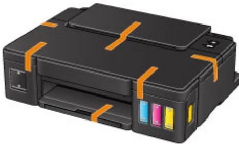
7. Coloque material de protección a ambos lados de la impresora cuando introduzca la impresora en la caja.
