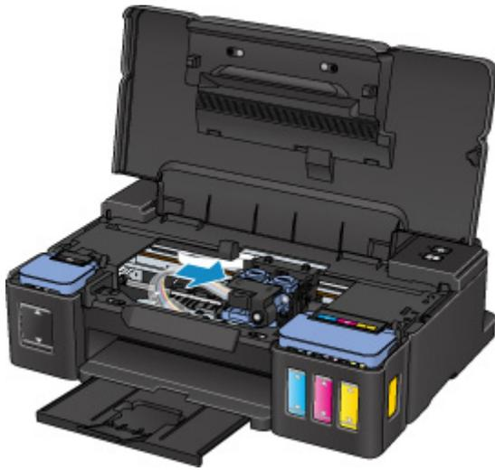
5. Compruebe que las tapas de los depósitos está cerradas correctamente.
