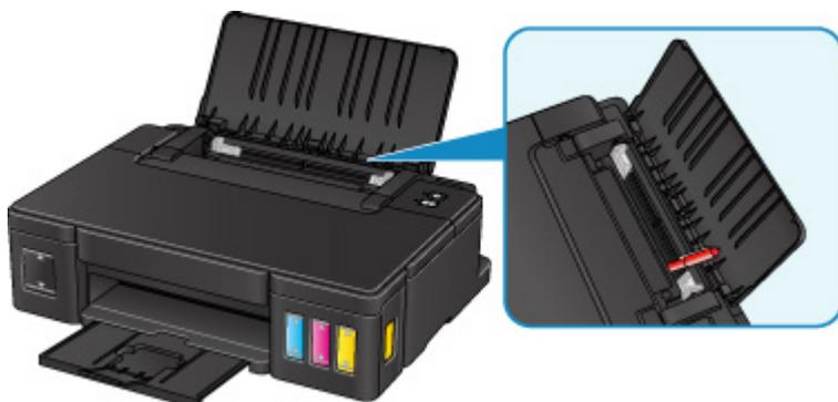
Si hay algún objeto extraño en la bandeja posterior, apague la impresora, desenchúfela y, a continuación, retire el objeto extraño.
