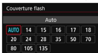
Avec les flashes Speedlite pourvus d'une tête de flash zoom, vous pouvez régler la couverture du flash. En règle générale, réglez cette option sur **[AUTO]** pour que l'appareil photo règle automatiquement la couverture du flash en fonction de la focale de l'objectif.
