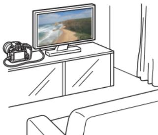
En raccordant l'appareil photo à un téléviseur avec un câble HDMI HTC-100, vous pouvez lire les photos et les vidéos de l'appareil photo sur le téléviseur.
