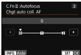
Vous permet de régler la sensibilité changeante des collimateurs AF à mesure qu'ils suivent le sujet bougeant beaucoup en haut, en bas, à gauche ou à droite. Ce réglage entre en vigueur lorsque le mode de sélection de la zone AF est réglé sur Sélection man.: Zone AF, sur Sélection man.: Zone large AF ou sur Sélection auto:45 coll.AF.
