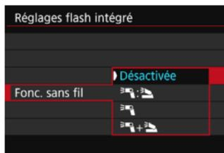
Avec la prise de vue avec flash sans fil (par transmission optique), vous pouvez utiliser les réglages du flash intégré pour contrôler un flash Speedlite externe sans fil.
