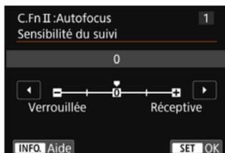
Règle la sensibilité de suivi du sujet dans le mode autofocus AI Servo lorsqu'un obstacle traverse les collimateurs AF ou lorsque les collimateurs AF s'éloignent du sujet.
