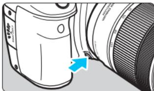
Appuyez sur la touche de contrôle de profondeur de champ pour redescendre à l'ouverture actuelle de l'objectif et vérifiez la profondeur de champ (plage de mise au point acceptable).
