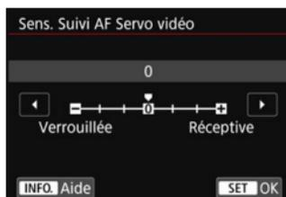
Vous pouvez modifier la sensibilité de suivi d'Autofocus Servo vidéo entre sept niveaux. Ceci affecte la réaction de la sensibilité du suivi autofocus lorsque les collimateurs AF s'éloignent du sujet, par exemple pendant un panoramique ou lorsqu'un obstacle traverse les collimateurs AF.
