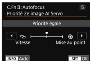
Vous pouvez régler les caractéristiques d'opération autofocus et le moment de déclenchement de l'obturateur pendant la prise de vue en continu après la première prise avec autofocus AI Servo.
