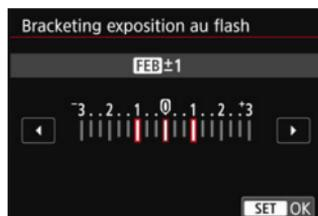
Trois photos sont prises lorsque la puissance du flash est changée automatiquement. Pour en savoir plus, consultez le mode d'emploi d'un flash Speedlite compatible avec le bracketing d'exposition au flash.
