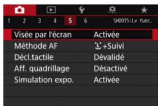
Lorsque le sélecteur de prise de vue avec Visée par l'écran / d'enregistrement vidéo est placé sur < 5 >, les options de menu spécifiques de la prise de vue avec Visée par l'écran apparaissent sous les onglets [ 5 ] et [ 6 ] (onglet [ 3 ] dans les modes de la zone élémentaire).
