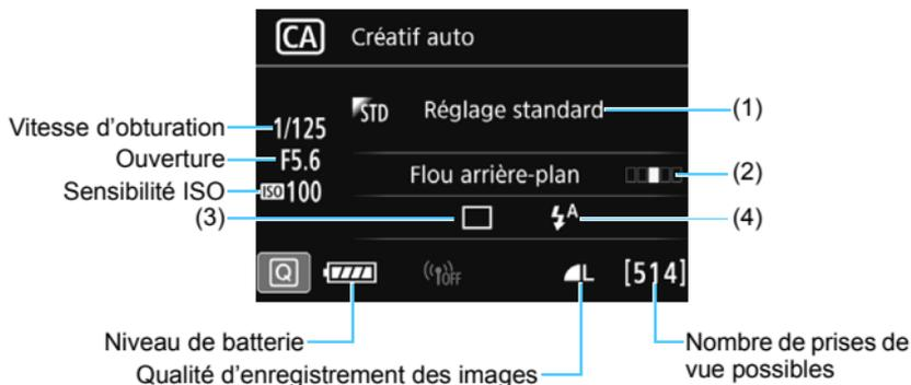
Si vous sélectionnez (1) ou (2) lorsque l'appareil photo est réglé pour la prise de vue avec Visée par l'écran, vous pouvez voir l'effet sur l'écran avant de commencer la prise de vue.
