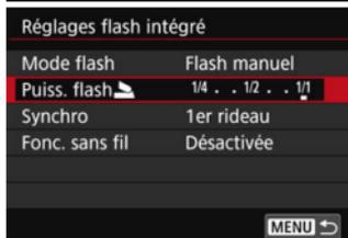
Pour régler manuellement le niveau de puissance du flash, sélectionnez **[Flash manuel]**.
