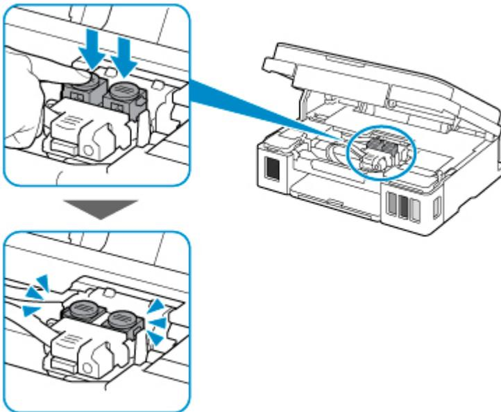
7. Cierre las dos cubiertas del depósito de tinta.
