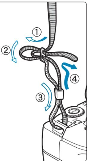
ストラップの先端をストラップ取り付け部の下から通し、さらにストラップに付いている留め具の内側を通します。留め具の部分のたるみを取り、引っぱっても留め具の部分がゆるまないことを確認してください。
