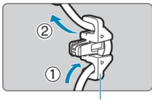
別売のキヤノン純正インターフェースケーブルを使用するときは、図のようにケーブルをクランパー部（5）に通してからプロテクター本体に取り付けてください。
