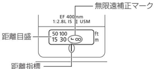
温度変化によるピント移動を補正するため、無限遠（∞）位置に余裕を持たせてあります。
