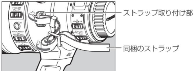
ストラップの先端を、ストラップ取り付け部に通し、さらにストラップに付いている留め具の内側を通します。ストラップを引っ張って、留め具の部分がゆるまないことを確認してください。
