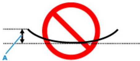
1. 下の図のように、対角線上の端を、反りと逆方向に丸める
