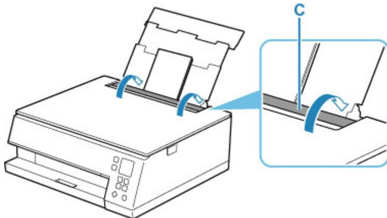
給紙口カバーを閉じると、液晶モニターに後トレイの用紙の設定を確認する画面が表示されます。
