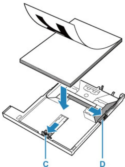
5. 手前の用紙ガイド (C) と右の用紙ガイド (D) を用紙の長さと幅に合わせる
