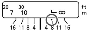
使用黑白红外胶片拍摄时，红外指示标记用于更正对焦设置。对主体进行手动对焦后，转动对焦环至对应的红外指示标记来调整距离设置。
