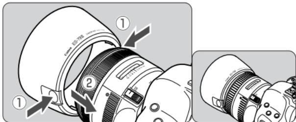
遮光罩 ES-79 II 能够阻挡不必要的光线进入镜头，并能保护镜头，使其避免受到雨、雪和灰尘的侵扰。请根据下列步骤安装遮光罩。
