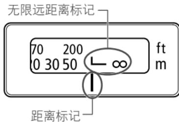
用于补偿由于温度变化而导致无限远对焦点的偏移。
