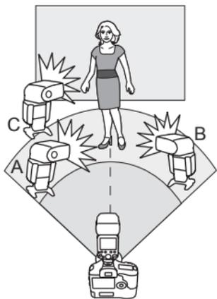
可以将闪光组C添加到闪光组A和B。C有助于消除被摄体阴影的照明。基本设定方法与“用两个从属组进行自动闪光拍摄”相同。
