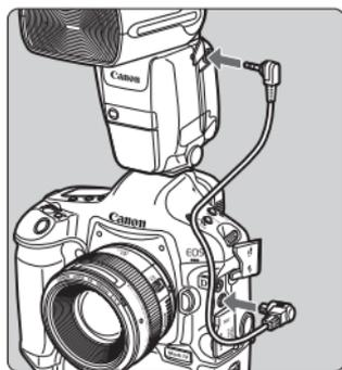
对于上述以外的兼容E-TTL II/E-TTL自动闪光并具有N3型遥控端子的EOS相机，需要有“快门线SR-N3”（另售）才能从从属单元进行遥控释放。
