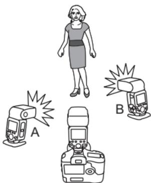
您可以將從屬單元分成A與B兩個閃燈組，並調整拍攝時的照明平衡度（閃光比例）。
