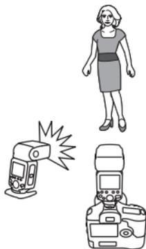
本節描述使用裝在相機上的600EX-RT（主控單元）與一支無線控制的600EX-RT（從屬單元）時，基本的全自動無線閃燈拍攝。
