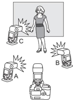
可以将闪光组C添加到闪光组A和B。C有助于设定照明以消除被摄体的阴影。基本设定方法与“用两个从属组进行自动闪光拍摄”相同。
