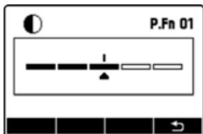
您可以用5個等級調整液晶顯示屏的對比度。
