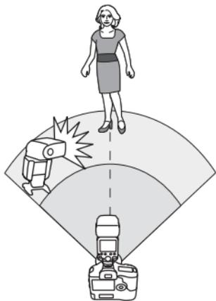
本節描述使用裝在相機上的600EX-RT/600EX（主控單元）與一支無線控制的600EX-RT/600EX（從屬單元）時，基本的全自動無線燈拍攝。
