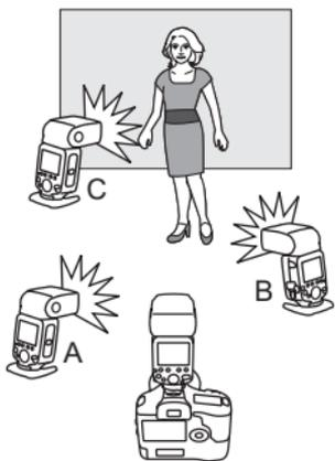
您可以將閃燈組C加入閃燈組A與B。C很方便設定照明以消除主體的陰影。基本設定方法與「用兩個從屬單元組進行自動閃光拍攝」一樣。
