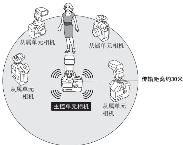
进行下一页上的操作之前，在用于联动拍摄的所有相机上安装闪光灯或信号发射器。有关信号发射器设置的详细说明，请参见信号发射器的使用说明书。
