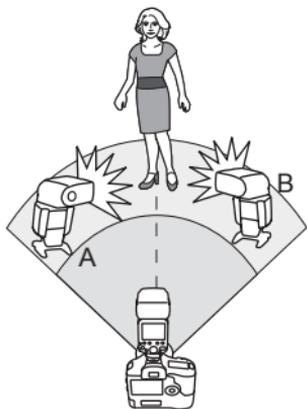
可以将从属单元分成两个闪光组A和B并调整拍摄用照明平衡（闪光光比）。
