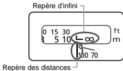
Pour corriger le décalage de mise au point lors d'une mise au point à l'infini qui pourrait résulter d'un changement de température.
