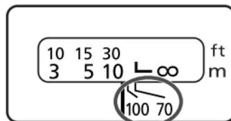
Le repère infrarouge corrige le réglage de mise au point lors de l'utilisation de films infrarouge en noir et blanc. Effectuez manuellement la mise au point sur le sujet, puis ajustez le réglage de la distance en déplaçant la bague de mise au point sur le repère infrarouge correspondant.
