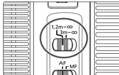
Vous pouvez régler la plage de distance de mise au point de 1,2 m à l'infini, ou de 3 m à l'infini. Ce réglage de la plage de distance de mise au point permet de réduire la durée effective de la mise au point.
