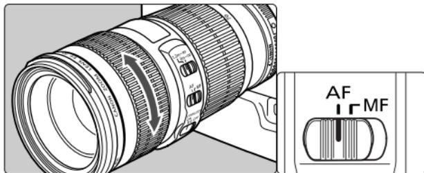
Pour effectuer des prise de vue avec mise au point automatique (AF), réglez le sélecteur de mode de mise au point sur AF.
