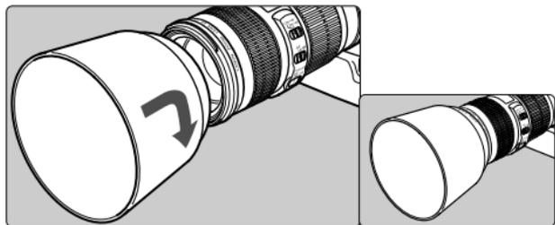
Le parasoleil ET-74 permet d'empêcher la lumière parasite de pénétrer dans l'objectif, et il protège également la face avant de l'objectif contre la pluie, la neige et la poussière. Montez et alignez le parasoleil sur la monture du parasoleil à l'avant de l'objectif et tournez le parasoleil comme indiqué par la flèche pour le fixer fermement.
