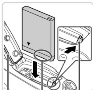
Joint d'étanchéité      Bornes      Verrou de la batterie
