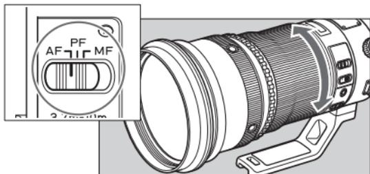
Pour effectuer des prises de vue avec mise au point automatique (AF), régler le sélecteur de mode de mise au point sur AF.
