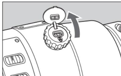
Une fente de fixation est disponible pour un verrou de sécurité par câble, sous le capot de la molette de verrouillage d'orientation. Vous pouvez vous procurer le verrou de sécurité par câble séparément.
