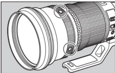
Le fonctionnement de l'autofocus peut être provisoirement interrompu à l'aide du bouton d'arrêt d'AF.
