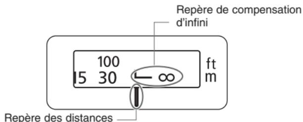
Pour corriger le décalage de mise au point pouvant résulter d'un changement de température à la mise au point sur l'infini. La position de l'infini à température normale est le point où la verticale du repère L de l'échelle des distances est alignée avec l'indicateur de distance sur le repère des distances.
