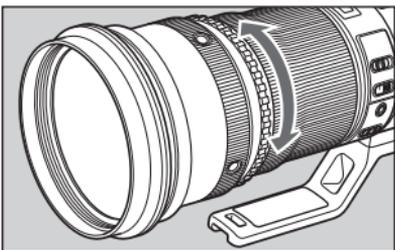
En tournant la bague d'annulation de pré réglage vers la gauche ou vers la droite, la mise au point change aussi loin que la distance pré réglée. La mise au point change librement en relâchant la mise au point AF lorsque la bague d'annulation de pré réglage est encore tournée.
