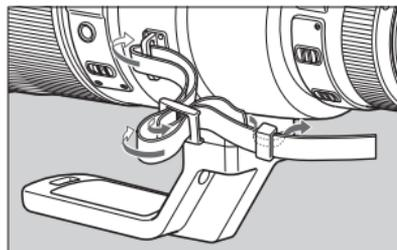
Faites passer l'extrémité de la bandoulière dans sa monture sur l'objectif puis la passer de nouveau dans l'attache de la bandoulière. Tirez sur la sangle et vérifiez qu'il n'y a pas de jeu dans l'attache.
