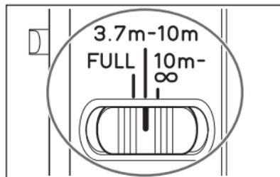
La plage des distances de mise au point peut être réglée par une commande. Ce réglage de la plage des distances de mise au point permet de réduire la durée effective de la mise au point.
