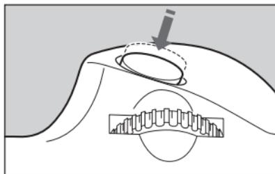
**2** Enfoncez le bouton du déclencheur à moitié pour mettre au point sur la distance que vous souhaitez pré régler.
