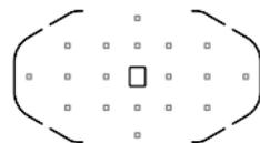
Com AI Servo AF, o ponto AF manualmente seleccionado (p.92) <□> é utilizado em primeiro lugar para se obter a focagem. Isto não pode ser definido nos modos totalmente automáticos (□/CA).
