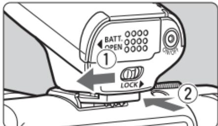
**1 将锁定杆滑动到左侧并将闪光灯安装到相机上。**
