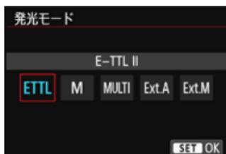
[E-TTL II] は、ストロボの自動撮影ができる、EXシリーズスピードライトの標準的なモードです。
