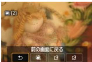
設定した枚数の撮影が完了する前に〈▶〉ボタンを押すと、撮影途中の（多重）画像が表示され、重なり具合や、露出などを確認することができます。
