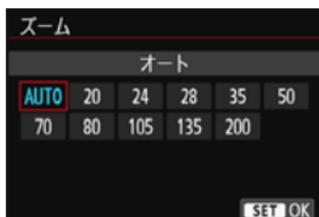
ズーム機能を内蔵したストロボ使用時に、発光照射角を設定することができます。通常は、撮影レンズの焦点距離に応じて照射角をカメラが自動設定する [AUTO] に設定します。
