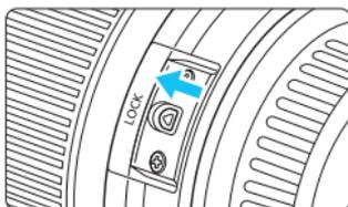
持ち運びの際にズームリングが動いて、レンズが伸び出ることを防ぐことができます。レンズをワイド端（18mm）にして、レンズ側面のズームリングロックレバーを〈LOCK〉方向にスライドさせます。ワイド端以外では、ロックできません。
