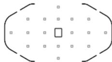
AIサーボAFのときは、初めに任意選択 (p.105) したAFフレーム〈□〉でピントを合わせます。ピントが合ったAFフレームは、〈□〉で表示されます。
