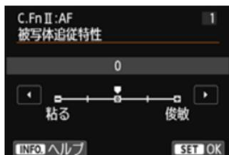
AIサーボAF時の測距中に、障害物がAFフレームを横切ったときや、AFフレームが被写体から外れたときの、被写体に対する追従性の設定です。
