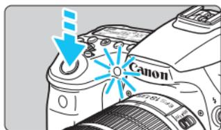
🔊 ファインダーから目を離してシャッターボタンを押すときは、ファインダーにアイピースカバーを取り付けてください (p.183)。ファインダーに光が入ると、適切な露出が得られないことがあります。
