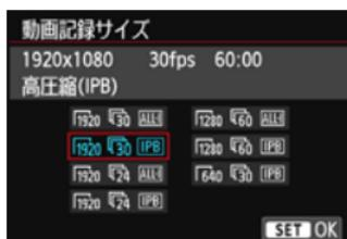
[**2**: 動画記録サイズ] で、動画の画像サイズ、フレームレート（1秒間に何コマ記録するか）、圧縮方式を設定することができます。なお、フレームレートは、[**3**: ビデオ出力方式] の設定により、自動的に切り換わります。
