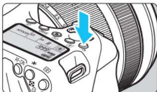
表示パネルの照明は、〈☼〉ボタンを押すたびに点灯 (☼6) / 消灯します。なお、バルブ撮影時は、シャッターボタンを全押しすると照明が消えます。
