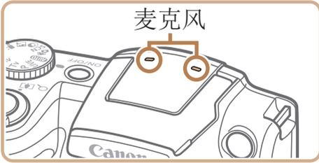
拍摄短片之前，请用手指按下闪光灯。请勿在拍摄短片时触摸麦克风。保持闪光灯升起或遮挡麦克风都可能会妨碍声音的记录，或可能导致记录的声音不清晰。
