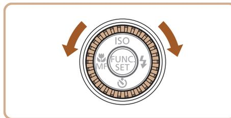
● 转动控制转盘可选择设置项目、切换图像以及执行其他操作，而其中大部分操作也可使用<▲><▼><◀><▶>按钮完成。
