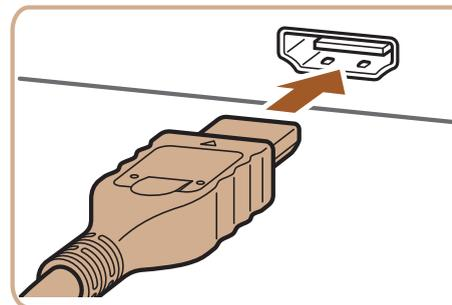
**1** 确保已关闭相机和电视机的电源。
