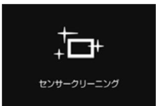
● 電源スイッチを〈ON〉にしたときと、〈OFF〉にしたときに、撮像素子の自動清掃が行われます（小さな音が鳴ることがあります）。清掃中は、液晶モニターに〈.□〉が表示されます。
