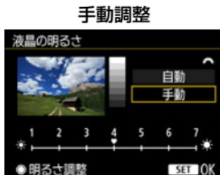
! [自動] のときは、サブ電子ダイヤルの左下にある丸い部分（外光センサー／p.24）を指などでふさがないようにしてください。
