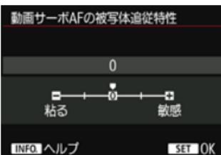
動画サーボAF中にパンニングを行ったり、障害物がAFフレームを横切ったときなど、AFフレームが被写体から外れたときの動画サーボAFの応答特性を、5段階で調整することができます。
