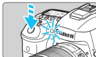
① ファインダーから目を離してシャッターボタンを押すときは、ファインダーにアイピースカバーを取り付けてください (p.247)。ファインダーに光が入ると、適切な露出が得られないことがあります。
