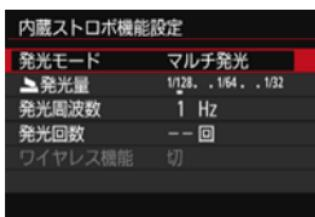
[マルチ発光] を選ぶと、低速シャッターで一枚の写真の中に連続した動きを分解写真のように、重ねて撮影することができます。
