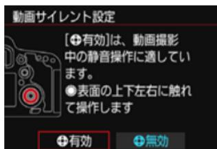
[**5:動画サイレント設定**] を [**有効**] に設定すると、サブ電子ダイヤルの内側にある、<**○**>（十字タッチパッド）が機能するようになります（<**A+**> は [**3**] タブ）。
