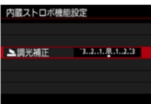
ストロボの発光量を1/3段ステップ±3段の範囲で調整することができます。
