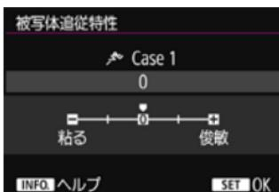
AIサーボAF時の測距中に、障害物がAFフレームを横切ったときや、AFフレームが被写体から外れたときの、被写体に対する追従性の設定です。
