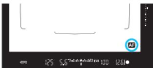
シャッターボタンを半押しして、AFでピント合わせを行っているとき（AF作動中）は、ファインダー視野内の右下に〈AF〉が表示されます。
