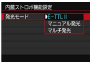
通常は [E-TTL II] を選びます。内蔵ストロボによる自動露出撮影を行うことができます。
