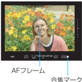
止まっている被写体の撮影に適しています。シャッターボタンを半押しすると、1回だけピント合わせを行います。
