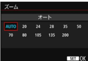
ズーム機能を内蔵したストロボ使用時に、発光照射角を設定することができます。通常は、撮影レンズの焦点距離に応じて照射角をカメラが自動設定する【AUTO】に設定します。
