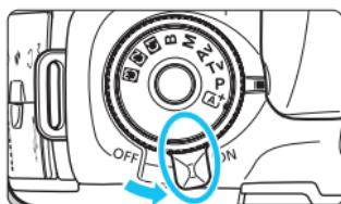
5 カメラの電源スイッチを〈ON〉にする
