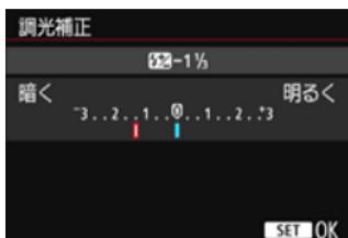
ストロボの発光量を1/3段ステップ±3段の範囲で調整することができます。
