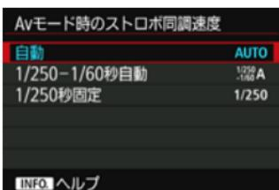
絞り優先AE（**Av**）モードでストロボ撮影を行うときのストロボ同調速度を設定することができます。
