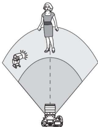
外部ストロボ1灯と内蔵ストロボを使つた全自动ワイヤレスストロボ撮影です。
