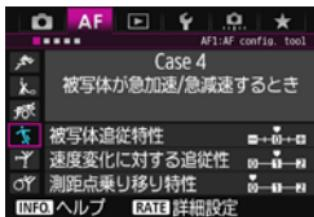
被写体の動く速さが瞬時に大きく変化しても、その速度変化に追従してピントを合わせようとする設定です。
