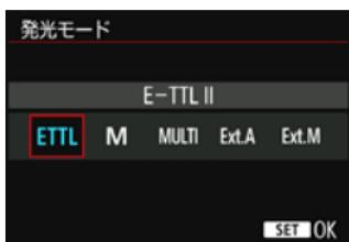
【E-TTL II】は、ストロボの自動露出撮影ができる、EXスピードライトの標準的なモードです。
