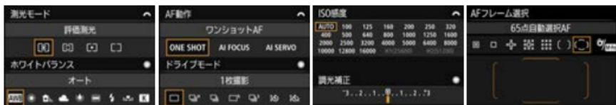
〔〕「撮影機能の設定状態」「水準器」の画面が表示された状態で電源を切ると、次に電源を入れたときに同じ画面が表示されます。解除するときは、〈INFO.〉ボタンを押して画面が表示されていない状態で電源を切ります。
