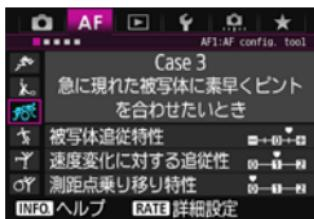
AFフレームで捉えた、距離の異なる被写体に、次々にピントを合わせることができる設定です。狙っていた被写体の手前に、新たな被写体が入り込んだときは、新たな被写体にピントを合わせます。最も近い被写体にピントを合わせたいときにも有効です。
