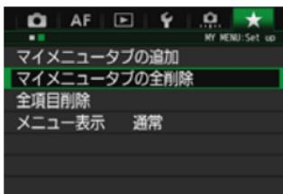
作成したすべてのタブの削除、作成したすべてのタブに登録されている全項目の削除を行うことができます。
