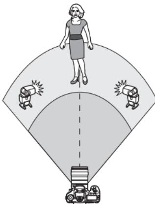
大きな発光量が必要なときに設定します。すべてのストロボが同じ光量で発光し、標準露出になるよう制御が行われます。
