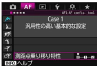
被写体が上下左右に大きく移動したときの、被写体に対する測距点（AFフレーム）の乗り移り（切り換わり）による、追従性の設定です。
