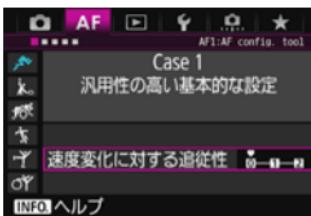
被写体が急に動き出したときや、急に止まったときなど、速さが瞬時に大きく変化したときの、被写体に対する追従性の設定です。
