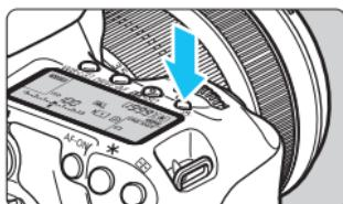
表示パネルの照明は、〈〉ボタンを押すたびに点灯（p.6）／消灯します。
