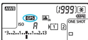
表示パネルと撮影機能の設定状態の画面に表示される [GPS] で、GPS信号の受信状態を確認することができます。
