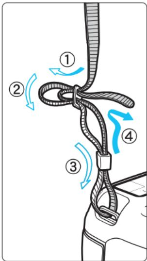
ストラップの先端をストラップ取り付け部の下から通し、さらにストラップに付いている留め具の内側を通します。留め具の部分のたるみを取り、引っ張っても留め具の部分がゆるまないことを確認してください。
