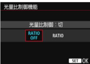
外部ストロボ機能設定に対応したマクロストロボ（例：MR-14EX II）使用時に、発光部A、Bの発光量の比率を設定したり、スレーブストロボを増灯したワイヤレスストロボ撮影を行うことができます。
