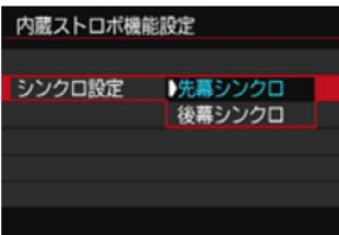
通常は、撮影開始直後にストロボが発光する【先幕シンクロ】に設定します。
