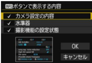
撮影準備状態で〈INFO.〉ボタンを押すと、「カメラ設定の内容」、「水準器」(p.75)、「撮影機能の設定状態」(p.469)を切り換えて表示することができます。
