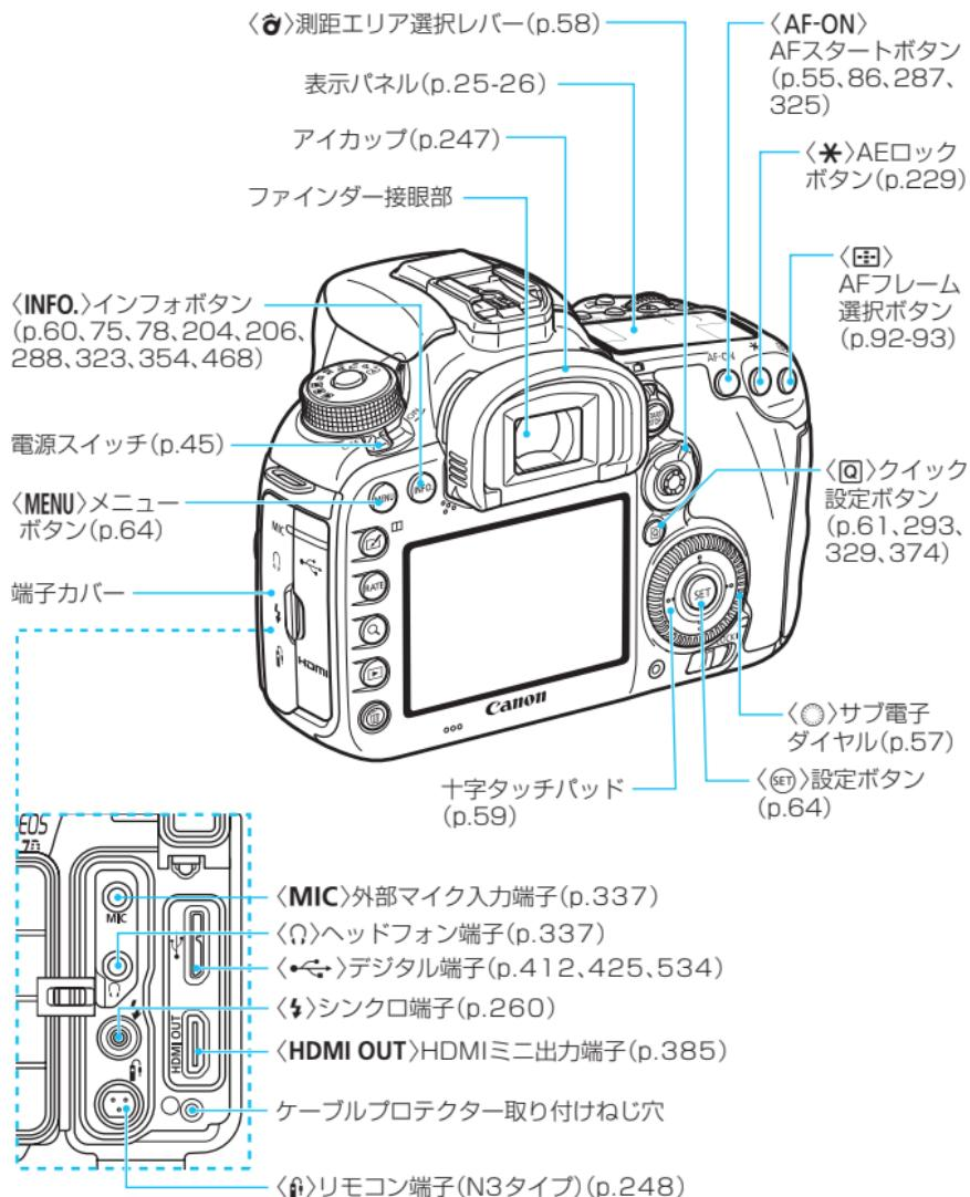
**●** デジタル端子にインターフェースケーブルを接続するときは、付属のケーブルプロテクターを使用してください。 (p.34)。
