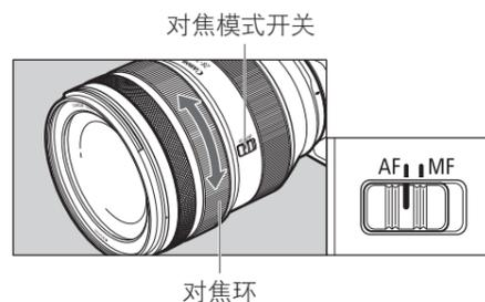
要在自动对焦 (AF) 模式下进行拍摄，请将对焦模式开关设置为 AF。如果仅要使用手动对焦 (MF)，请将对焦模式开关设置为 MF，并转动对焦环进行对焦。
