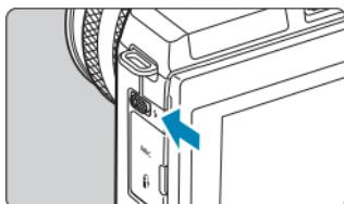
**1** С помощью рычага <
