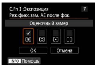
Для каждого режима замера можно указать, требуется ли фиксировать экспозицию (Фиксация AE) после завершения фокусировки на объекты в режиме покадрового AF. Экспозиция остается фиксированной, пока кнопка спуска затвора удерживается наполовину нажатой. Выберите режимы замера экспозиции для фиксации AE и установите флагки [✓]. Выберите [OK] для регистрации настройки.
