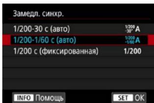
Можно задать выдержку синхронизации вспышки для съемки со вспышкой в режиме автоз曝露ции с приоритетом диафрагмы <Av> или в режиме программной AE <P>.
