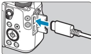
**2 Подключите камеру к компьютеру интерфейсным кабелем IFC-100U (продаётся отдельно; со стороны компьютера: USB тип C).**
