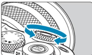
Следя за индикацией на экране, поворачивайте диск < >. Используйте этот диск для задания выдержки, значения диафрагмы и т. д.
