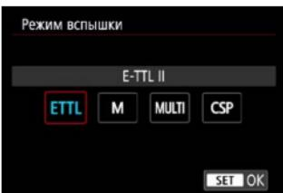
**[E-TTL II]** — стандартный режим вспышек Speedlite серии EL/EX для автоматической съемки со вспышкой.
