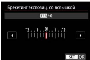
Внешние вспышки Speedlite с функцией брекетинга экспозиции со вспышкой (FEB) могут автоматически изменять мощность вспышки: при съемке трех кадров подряд.
