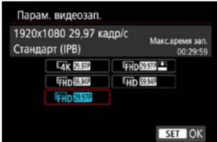
На вкладке [**Фото: Качество видео**] выберите [**Парам. видеозап.**], чтобы задать размер изображения, частоту кадров и метод сжатия. Видеофильм будет записан как файл MP4. Частота кадров, отображаемая на экране [**Парам. видеозап.**], автоматически переключается в зависимости от настройки [**ТВ-стандарт**] (502).
