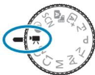
Для видеосъемки поверните диск установки режима в положение <>.
