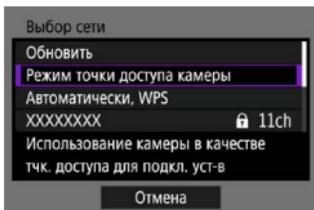
Режим точки доступа камеры предназначен для подключения камеры по Wi-Fi непосредственно к каждому устройству. Он отображается при выборе в пункте [Функция Wi-Fi] значения [□], [■] или [△].
