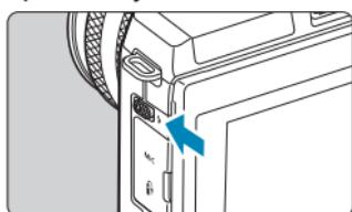
**1 С помощью рычага <↑> поднимите встроенную вспышку.**
