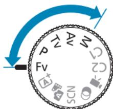
Режимы творческой зоны обеспечивают свободу съемки различными способами за счет задания требуемой выдержки затвора, величины диафрагмы, экспозиции и т. п.
