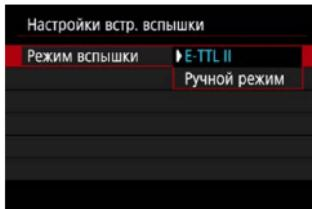
Задайте значение [**E-TTL II**] для съемки в режиме полностью автоматической вспышки E-TTL II/E-TTL.
