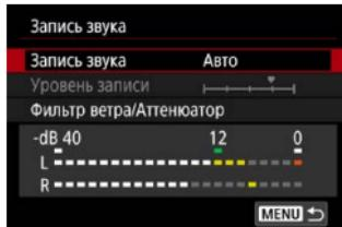
Запись звука во время видеосъемки возможна с помощью встроенного стереофонического микрофона или внешнего стереофонического микрофона. Также можно свободно регулировать уровень записи звука.
