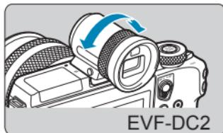
**6** Завершив съемку, снимите электронный видоискатель.
