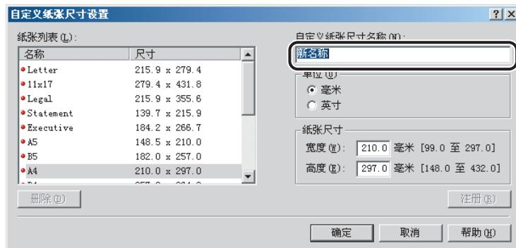
**5 在“单位”中选择指定纸张尺寸的度量单位 → 在“高度”和“宽度”中指定高度和宽度。**
