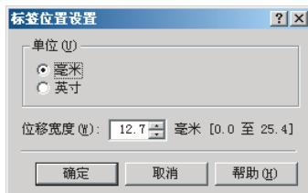
**4 在“位移宽度”中指定宽度以移动要打印到纸张标签部分的图像。**
