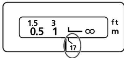
使用黑白红外胶片拍摄时，红外指示标记用于更正对焦设置。对主体进行手动对焦后，转动对焦环至对应的红外指示标记来调整距离设置。
