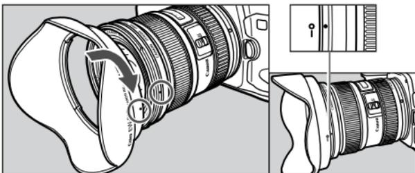
遮光罩EW-83E能够阻挡不必要的光线进入镜头，并能保护镜头，使其避免受到雨、雪和灰尘的侵扰。安装遮光罩时，将遮光罩的安装位置标记对准镜头前部的红色圆点，然后按箭头所示的方向转动遮光罩，直至镜头的红色圆点与遮光罩停止位置标记排成一线。
