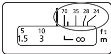
使用黑白红外胶片拍摄时，红外指示标记用于更正对焦设置。对主体进行手动对焦后，转动对焦环至对应的红外指示标记来调整距离设置。
