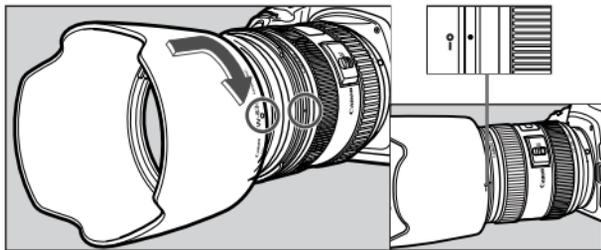
遮光罩EW-83F能够阻挡不必要的光线进入镜头，并能保护镜头，使其避免受到雨、雪和灰尘的侵扰。安装遮光罩时，将遮光罩的安装位置标记对准镜头前部的红色圆点，然后按箭头所示的方向转动遮光罩，直至镜头的红色圆点与遮光罩停止位置标记排成一线。
