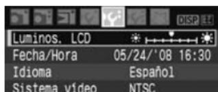
Bajo la ficha [14], seleccione [**Luminos. LCD**] y, a continuación, presione <Ⓢ>. Con la pantalla de ajuste visualizada, presione la tecla <◀▶> para ajustar la luminosidad y, a continuación, presione <Ⓢ>.
