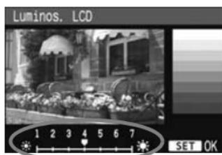
Cuando revise la exposición de una imagen, ajuste la luminosidad del monitor LCD en 4 y evite que la luz ambiente afecte a la imagen que esté revisando.
