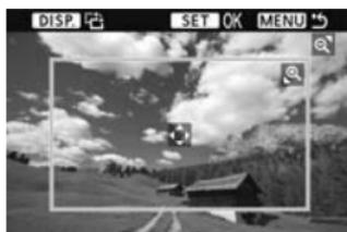
Puede recortar la imagen e imprimir solamente la parte recortada, como si se volviera a encuadrar la imagen. **Realice el recorte justo antes de imprimir.** Si ajusta el recorte y, a continuación, los ajustes de impresión, puede que deba volver a ajustar el recorte.
