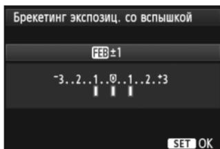
Мощность вспышки автоматически изменяется для трех последовательных кадров. Подробные сведения о FEB (Брекетинг экспозиции вспышки) см. в инструкции по эксплуатации вспышки Speedlite.
