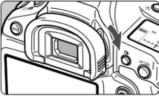
Если при съемке с автоспуском или с длительной выдержкой пользователь не смотрит в видоискатель, свет, попадающий через окуляр, может повлиять на определение экспозиции и сделать снимки более темными. Во избежание этого закройте окуляр, сдвинув рычаг шторки окуляра, как показано стрелкой. При съемке с использованием ЖКД-видоискателя или видеосъемке использовать шторку окуляра не требуется.
