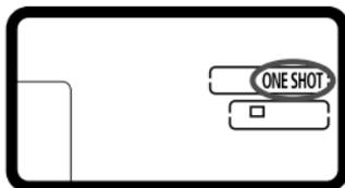
Подходит для неподвижных объектов. При нажатии кнопки спуска затвора наполовину камера фокусируется только один раз.
