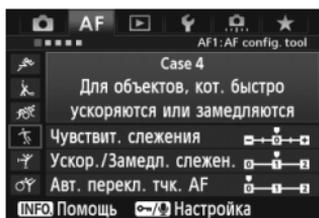
Для объектов, склонных к неожиданным резким изменениям скорости. Эффективно для объектов с внезапным изменением направления движения, ускорением/замедлением или внезапными остановками.
