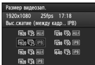
В меню [CAMERA 4: Размер видеозап.] можно задать размер видеоизображения, количество записываемых в секунду кадров (скорость видеозаписи) и метод сжатия данных. Скорость видеозаписи автоматически переключается в зависимости от значения, заданного для параметра [CAMERA 3: ТВ-стандарт].
