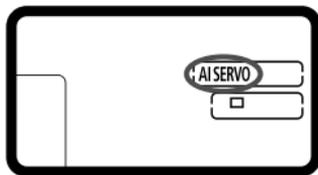
Этот режим автофокусировки пригоден для съемки движущихся объектов, когда расстояние фокусировки постоянно изменяется. Пока кнопка спуска затвора удерживается наполовину нажатой, производится непрерывная фокусировка на объект.
