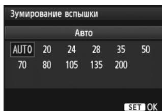
Головка вспышек Speedlite оснащена зумом, что позволяет задавать для вспышки различный угол освечивания. Обычно выбирается пункт **[AUTO]**, так чтобы камера автоматически устанавливала угол освечивания, соответствующий фокусному расстоянию объектива.
