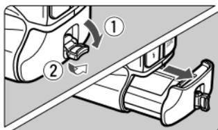
Поверните ручку фиксатора аккумулятора и извлеките аккумулятор.
