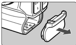
**1** Снимите крышку отсека аккумулятора.
