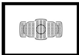
Съемка в режимах автофокусировки с использованием 61 точки автофокусировки в видоискателе подходит для самых различных объектов и сцен.
