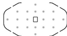
Bei AI Servo AF wird das manuell gewählte (S. 92) AF-Messfeld  $\langle \square \rangle$  zuerst zur Scharfeinstellung verwendet. Diese Einstellung ist nicht in den vollautomatischen Modi verfügbar ( $\square / \text{CA}$ ).
