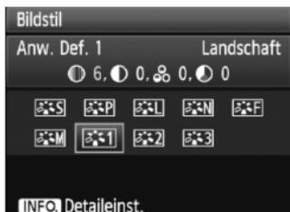
Wenn unter [**Anw. Def. \***] bereits ein Bildstil gespeichert wurde und Sie den dafür verwendeten Basis-Bildstil wie in Schritt 4 beschrieben ändern, werden die Parametereinstellungen des gespeicherten Bildstil zurückgesetzt.
