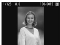
Aufnahmen im Hochformat werden automatisch gedreht, damit sie auf dem LCD-Monitor der Kamera und dem Computer im Hoch- und nicht im Querformat angezeigt werden. Die Einstellung für diese Funktion kann angepasst werden.
