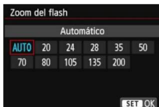
Con los flashes Speedlite que tienen cabeza de flash con zoom se puede ajustar la cobertura del flash. Normalmente, ajuste esta opción en **[AUTO]** para que la cámara ajuste automáticamente la cobertura del flash de modo que coincida con la longitud focal del objetivo.
