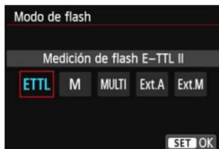
**[Medición de flash E-TTL II]** es el modo estándar de los flashes Speedlite serie EX para el disparo con flash automático. El modo **[Flash manual]** es para que usted realice sus propios ajustes de **[Nivel de potencia del flash]** del flash Speedlite.
