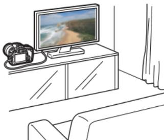
Utilice el cable HDMI HTC-100 (se vende por separado) o el cable AV estéreo AVC-DC400ST (se vende por separado) para conectar la cámara a un televisor. Así podrá reproducir en un televisor los vídeos y las fotos que haya captado.
