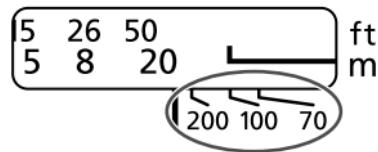
用于补偿由于温度变化而导致无限远对焦点的偏移。
