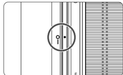
安装遮光罩时，将遮光罩的安装位置标记对准镜头前部的红色圆点，然后按箭头所示的方向转动遮光罩，直至镜头的红色圆点与遮光罩停止位置标记排成一线。
